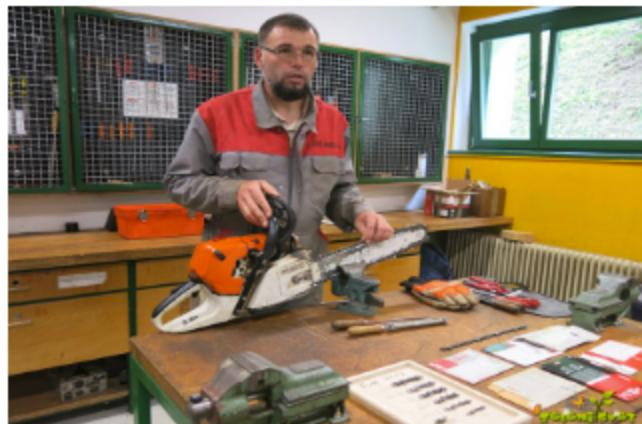
Pred brušenjem motorne žage je treba določiti katero verigo imamo na motorni žagi. Po tem izberemo pilo, ki je primerna glede na tip verige. Pravilno brušenje je zelo pomembno, zato upoštevajte navodila za delo. Pri delu z motorno žago ne pozabite tudi na priostritev verige. Delavec za motorno žago bo manj obremenjen in bolj zdrav.
