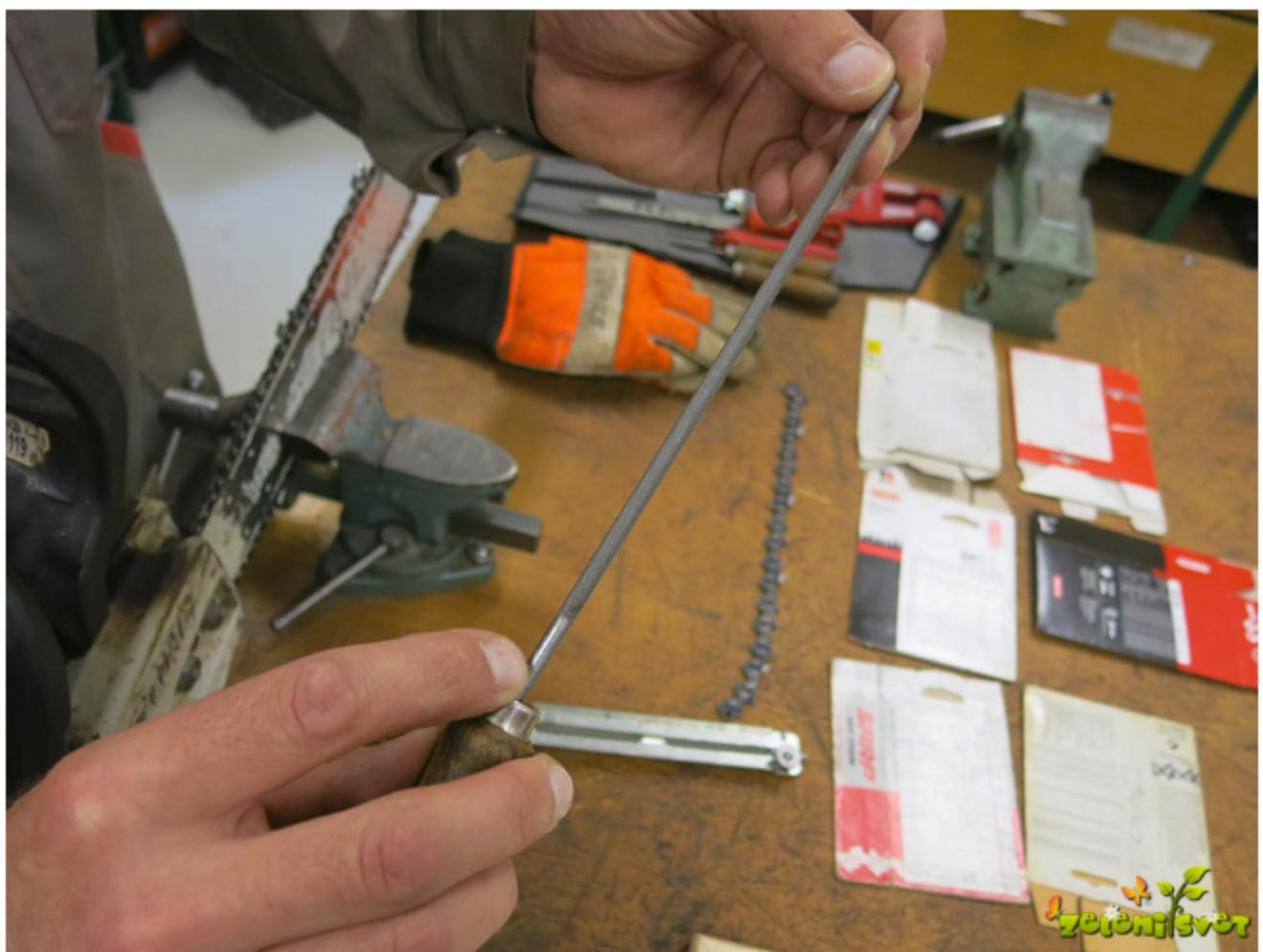
Izberite pravilno pilo za brušenje.
