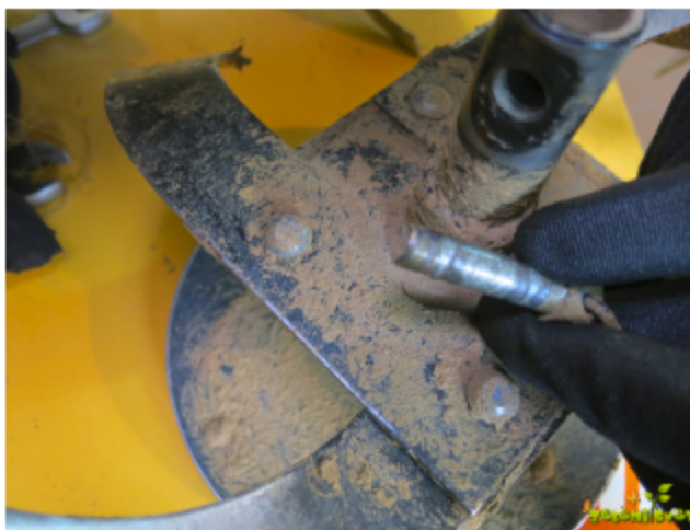
Obrabljene varovalne sornike zamenjamo.
